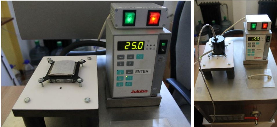
Slika 17 Elektrostatski cikulator s postavljenim uzorkom na pločici (lijevo) i spektrofotometrom prilikom mjerenja (desno)
