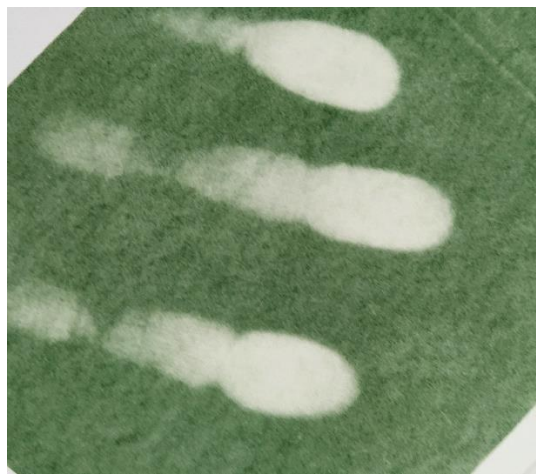
Slika 2. Prikaz promjene obojenja zelene termokromne boje kada se otisak dodirne rukama
