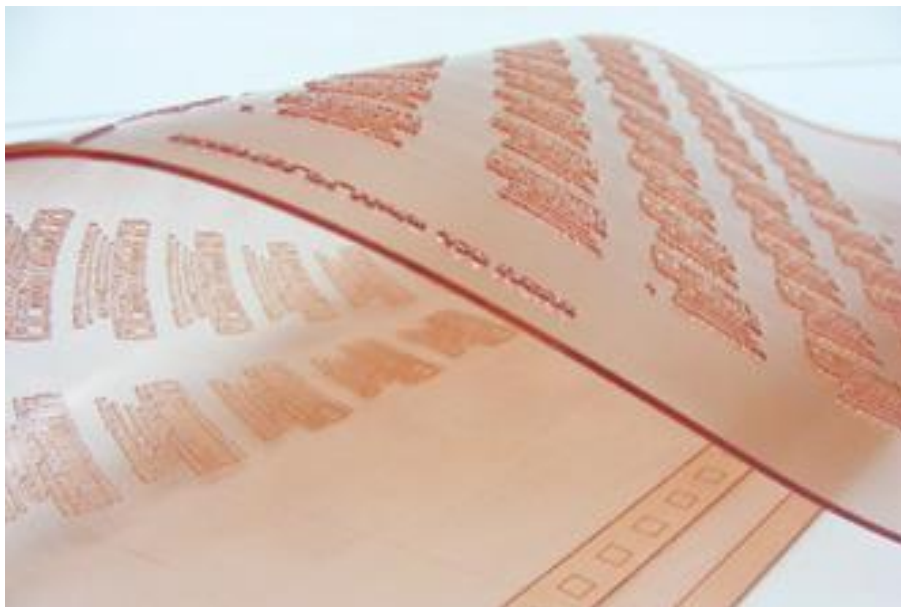
Slika 3: Tiskovna forma za fleksotisak
