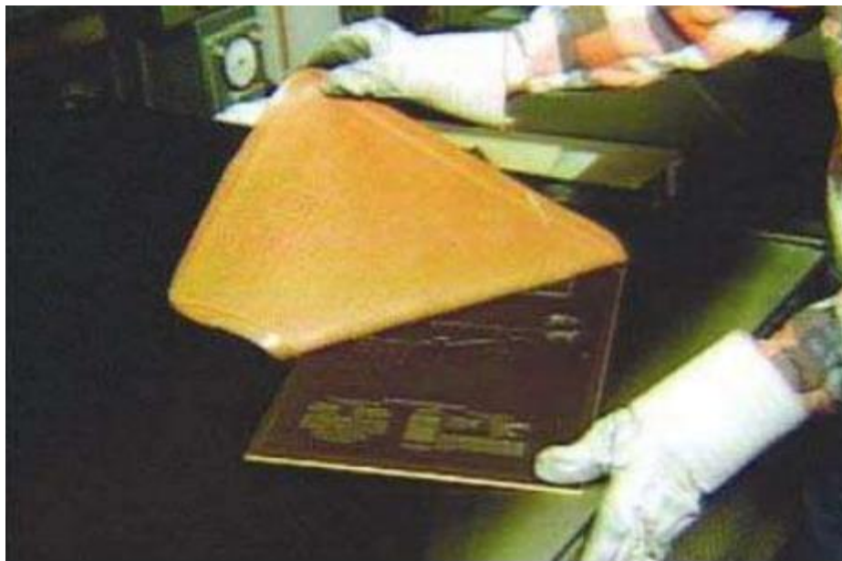
Slika 2: Izrada gumene tiskovne forme
