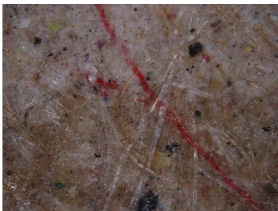
Slika 44. Mikroskopska snimka recikliranog papira na kojeg je tiskano UV luminescentnim lakom (s dodatkom 1,0% TiO 2 nanočestica)
