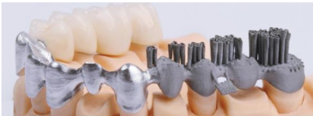
Slika 3. Dentalni implantati nastali DMLS 3D ispisom
