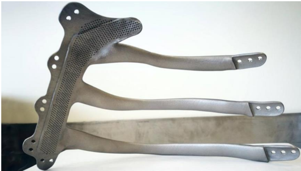
Slika 16. Titanski dio Renishaw-ovog prsnog koša
