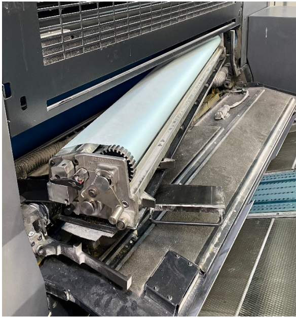
Slika 17. Aparat za pranje gumene navlake Slika 18. Aparat za pranje tiskovnog cilindra
