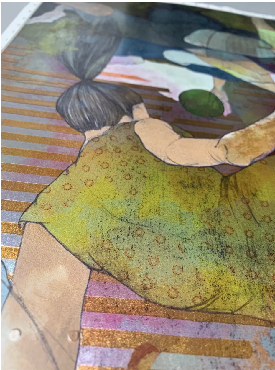
Slika 18 Kombinacija UV laka i digitalnog foliotiska
