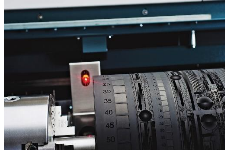
Slika 4.26 a) Lasersko graviranje ovojne tiskovne forme, b) CtP Laserska izrada tiskovne forme[13]
