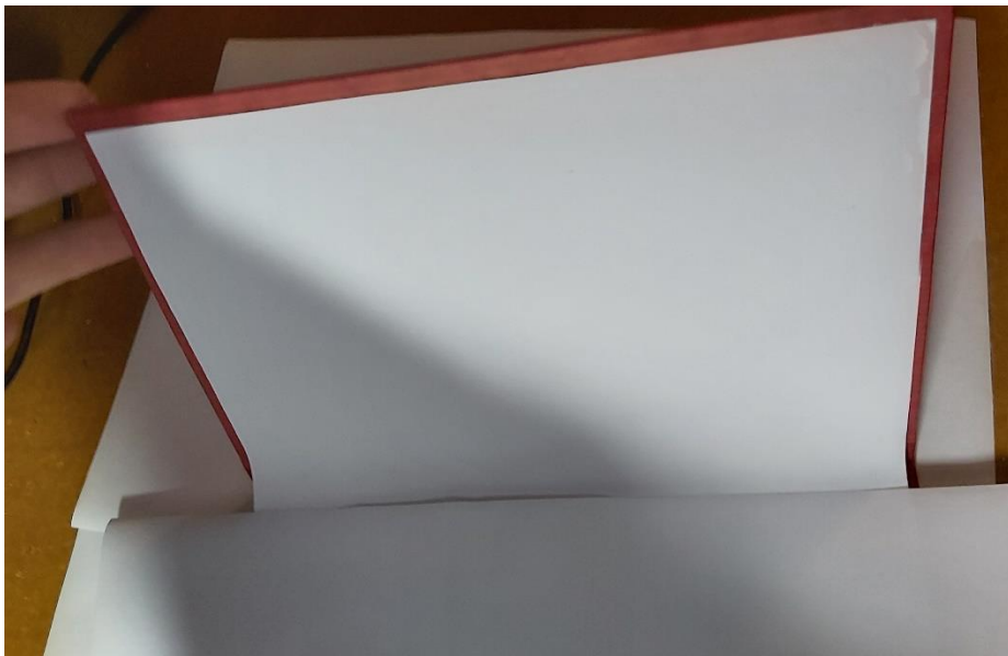
Slika 50. Uljepljivanje druge podstave na korice
