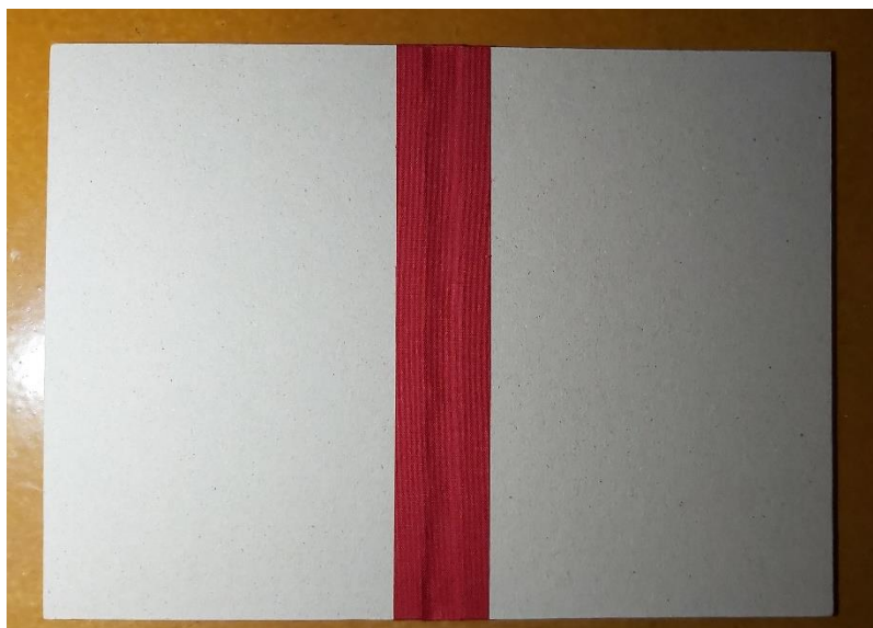
Slika 37. Prirezi povezani platnenom vezicom
