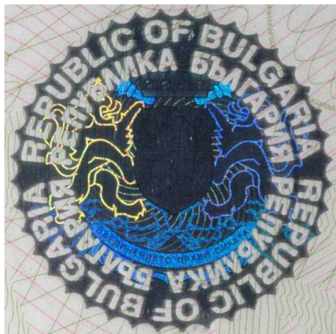
Slika 17 - Djelomično de-metalizirani (lijevo) i metalizirani kinegram (desno)
