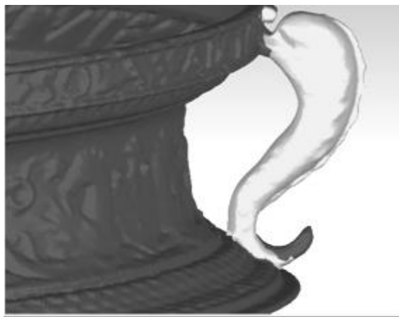
Slika 21. Preklapanje dvaju modela dobiveno globalnom registracijom
