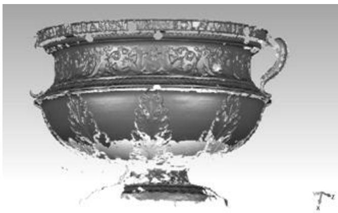
Slika 6. Otvaranje *.stl datoteke u Geomagic program nakon 3D skeniranja
