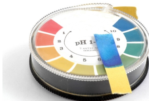
Slika 2. Halokromna boja u pH indikatorskoj traci
