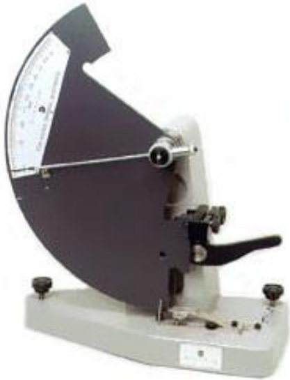
Slika 17. Mjerni uređaj Elmendorf za određivanje otpornosti prema cijepanju [47]
