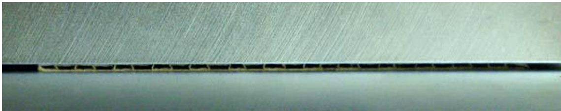
Slika 23. Epruveta pod najvećim stlačivanjem
