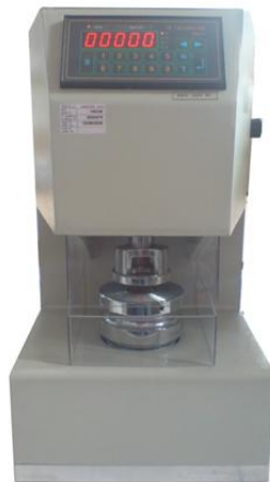
Slika 16. Uređaj za ispitivanje otpornosti papira prema prskanju po Mullenu
