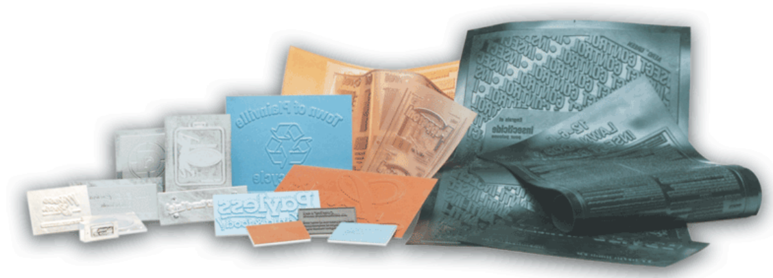
Slika 3. Tiskovne forme za fleksotisak (izvor: http://www.sterling.ca/flexo.cfm )
