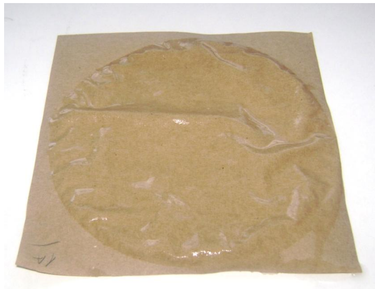
Slika 27. Uzorak papira nakon izlijevanja vode i odstranjivanja viška vode bugačicom
