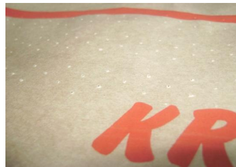
Slika 10. Izgled perforacije na ventil vreći
