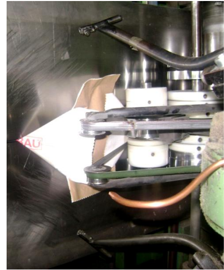
Slika 20. Otvaranje dna na ventil stroju
