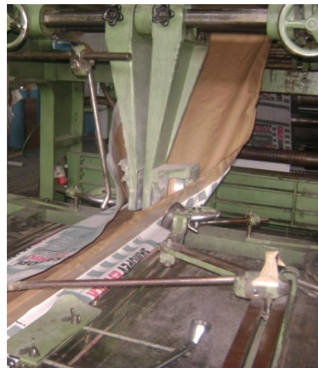
Slika 18. Sistem diskova i vodicica na Tubijeri
