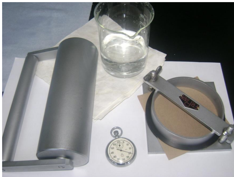
Slika 26. Skica uređaja za određivanje površinske upojnosti po Cobbu
