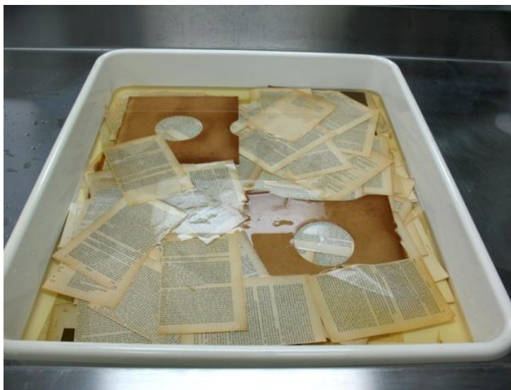
Slika 7 – Mokro čišćenje postupkom uranjanja listova papira u tekućinu
