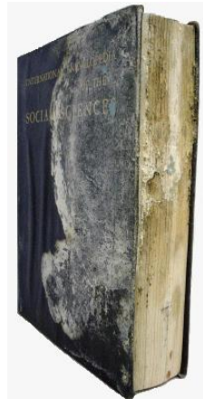
Slika 3 – Vidljiva oštećenja nastala pod utjecajem plijesni
