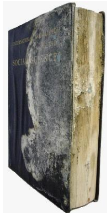
Slika 3 – Vidljiva oštećenja nastala pod utjecajem plijesni
