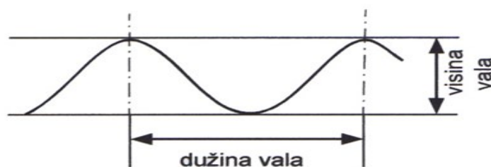
Slika 6. Prikaz mjera za dužinu i visinu vala
