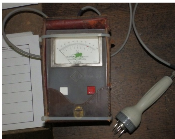
Slika 22. Higrometar korišten za mjerenje vlage u gotovom valovitom kartonu
