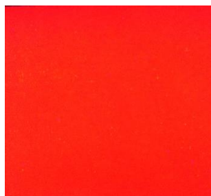
Slika 51. Otisak UV luminiscentne crvene boje na crnom nepremazanom papiru (3 g pigmenta + 50 g baze)
