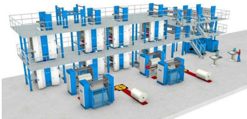
Slika 2. König-Bauer stroj za novinski tisak (etažni)
