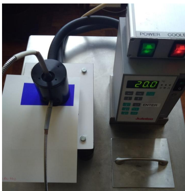
Slika 7. Mjerenje kolorimetrijskih promjena pomoću spektrofotometra Ocen OpticsUSB 2000+
