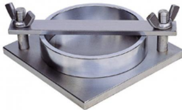
Slika 5. Uređaj za određivanje površinske upojnosti
