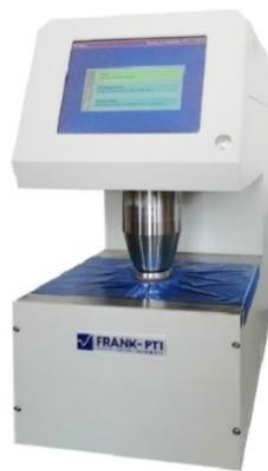
Slika 4. Uređaj PTI – Line Bekk
