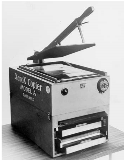
Slika 2. Fotografija prvog automatiziranog elektrofotografskog fotokopirnog stroja tvrtke Xerox (Izvor: http://media-3.web.britannica.com/eb-media/88/144288-004-DF505E4E.jpg )
