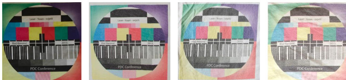
Slika 51 Laserski tisak na bijelim majicama Laser – Yosan - 40°C (neoprano, prvo, drugo i treće pranje)
