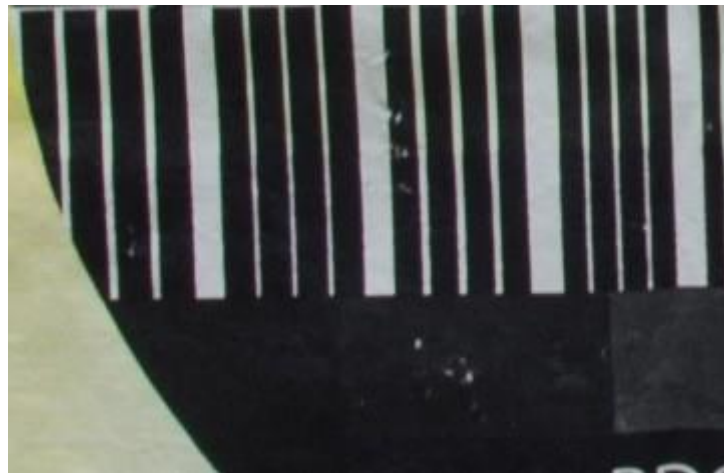
Slika 53 Oštećenja nakon pranja na 60°C - Laser - Dark
