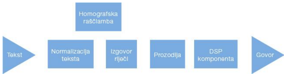
Slika 9 — Komponente sustava za sintezu govora
