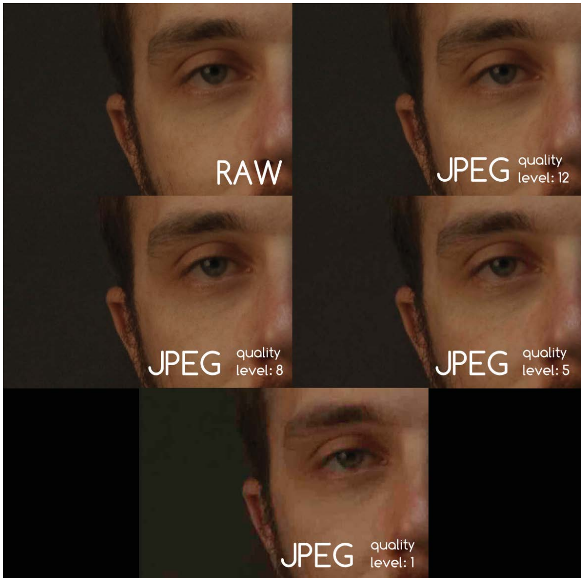
Slika 22. Usporedni prikaz RAW i softverske JPEG konverzije različitih razina kvalitete
