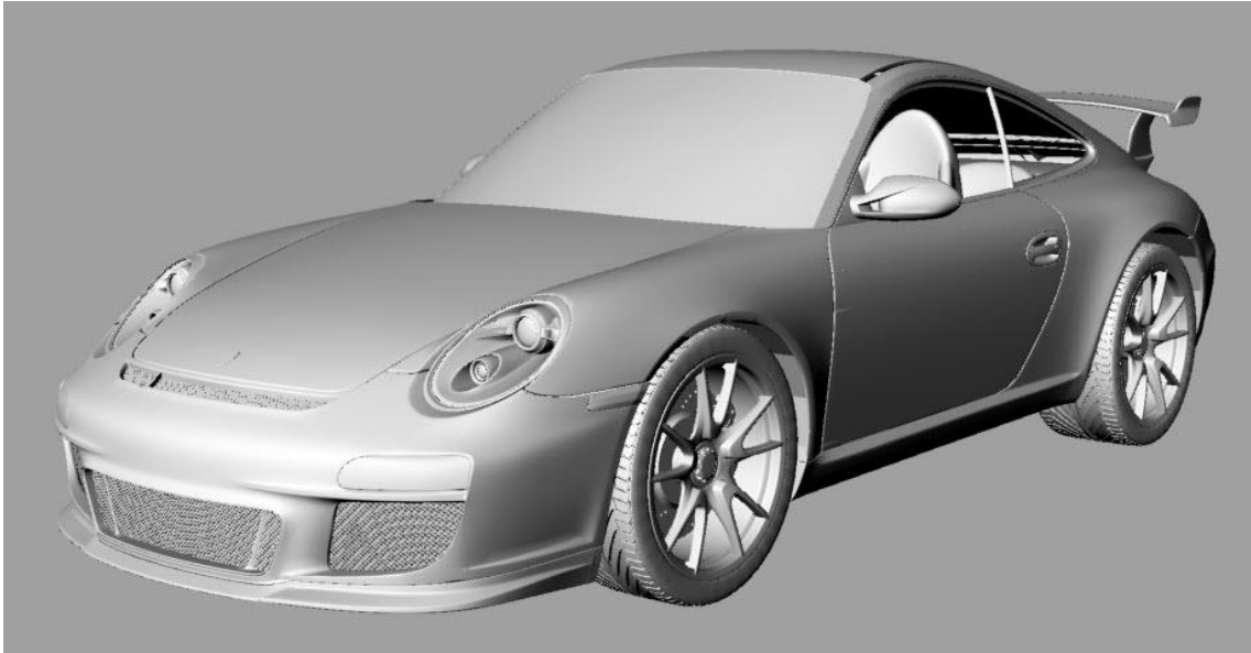
Slika 8 - model automobila dobiven NURBS modeliranjem (preuzeto sa: http://goo.gl/kFa6cZ )
