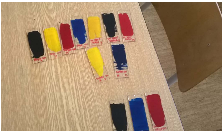
Slika 28. Primjer sušenja različitih otisaka staklenoj podlozi
