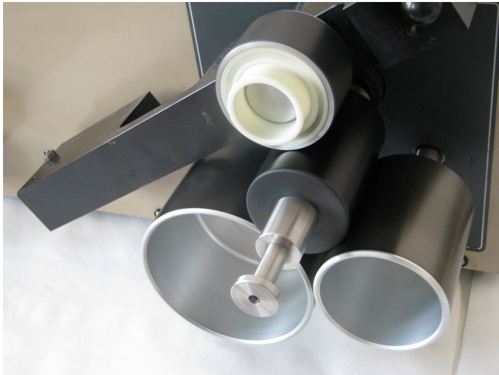
Slika 21. Sustav valjaka na IGT C1 stroju
