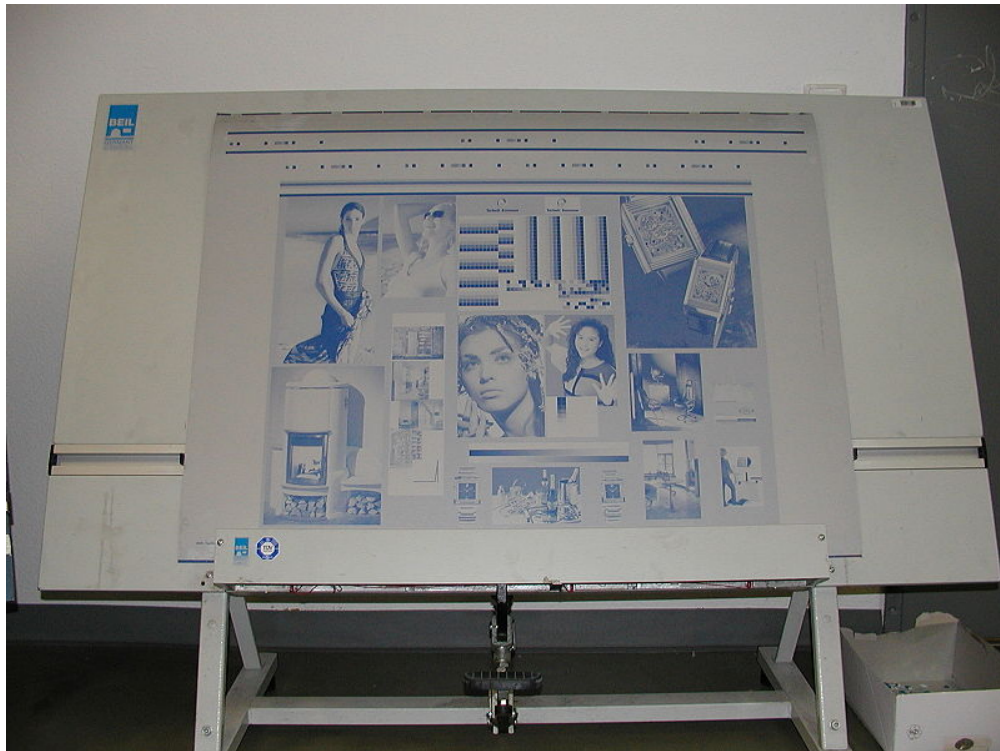
Slika 1. Tiskovna forma za plošni tisak
