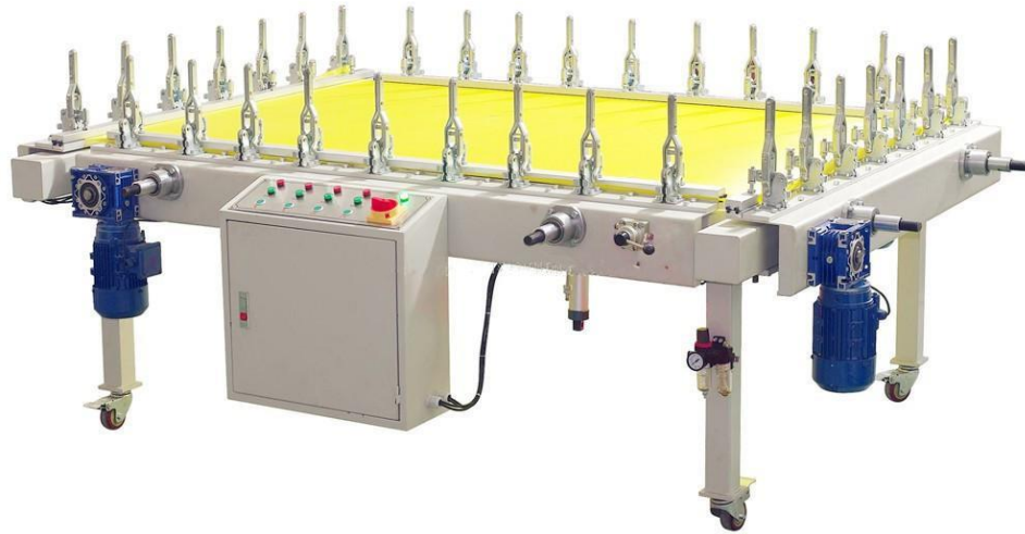
Slika 4. Uređaj za pneumatsko napinjanje sita [5] (Izvor: http://www.chinabestprice.com )
