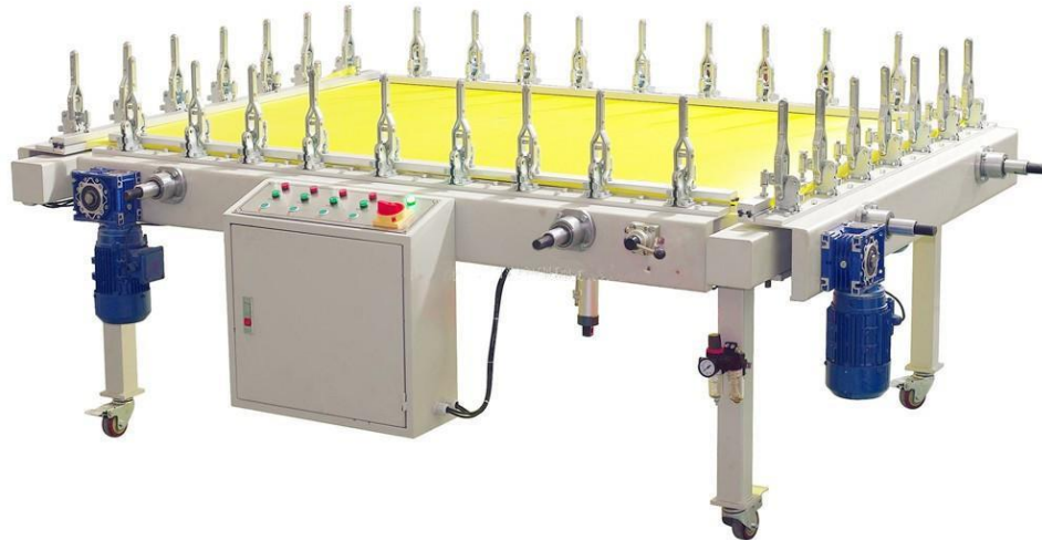
Slika 4. Uređaj za pneumatsko napinjanje sita [5] (Izvor: http://www.chinabestprice.com )
