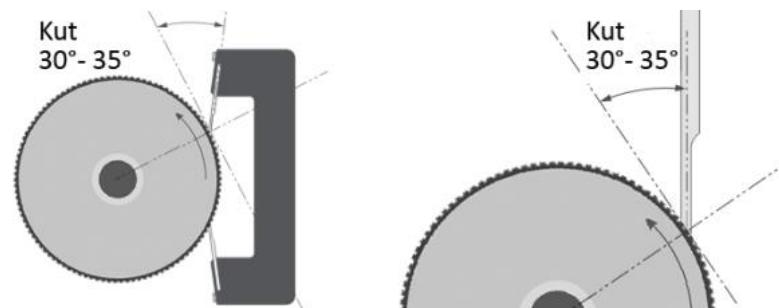
Slika 5. Kut oštrice odstranjivača bojila prema aniloks valjku kod dva različita sustava za obojenje
