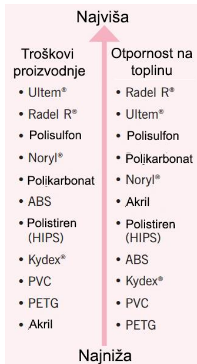
Slika 2. Usporedba troškova proizvodnje i termostabilnosti amorfnih termoplasta [8]
