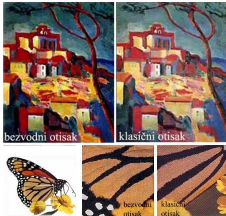
Slika 9. Primjeri otisaka višebojne reprodukcije te usporedba kvalitete između otisaka bezvodnog i klasičnog ofsetnog tiska [15]
