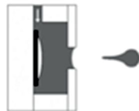
Slika 21. Formiranje kapljice tehnologijom termalnog Inkjeta
