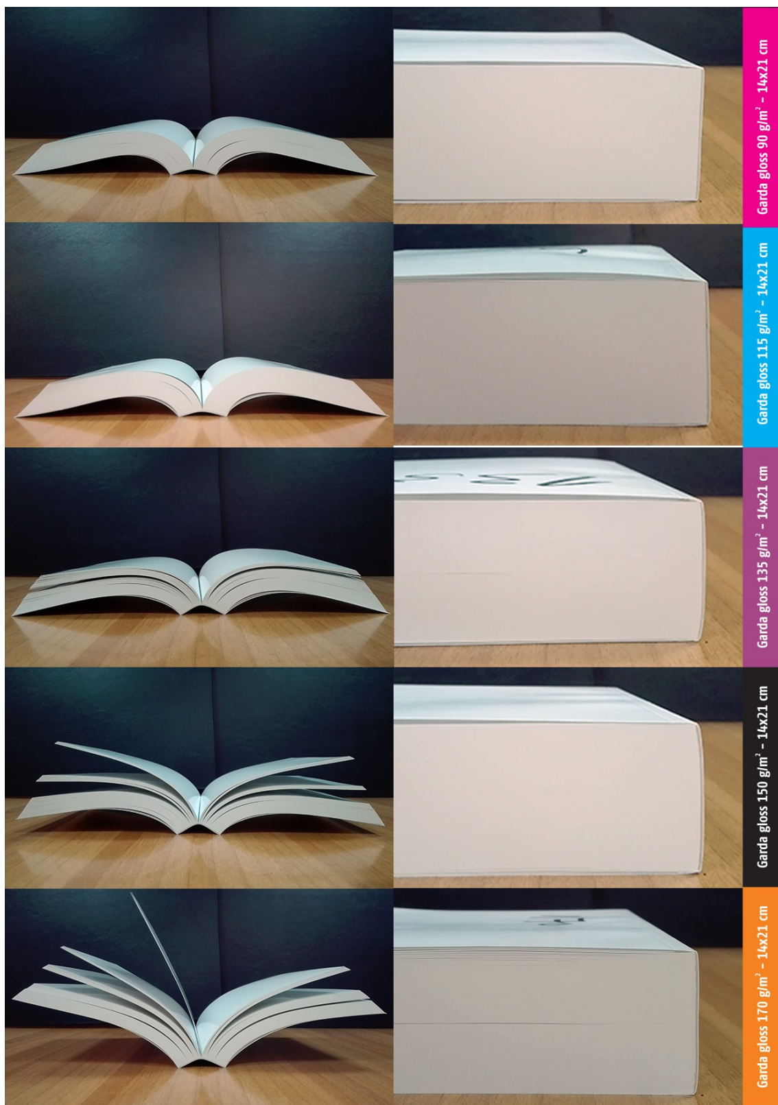
Slika 26. Knjige formata 14,8x21 cm, izrađena od papira garda gloss 90 g/m 2 , 115 g/m 2 , 135 g/m 2 , 150 g/m 2 , 170 g/m 2 , prikaz otvaranja knjige i deformacije hrpta
