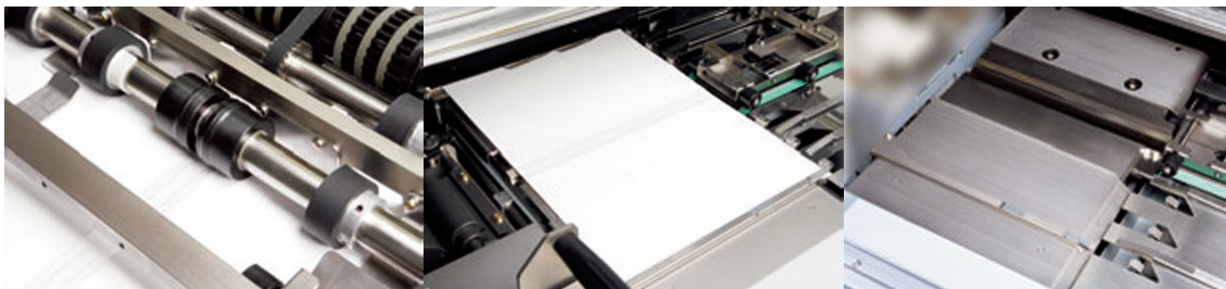
Slika 17: Uređaja za žljebanje korice, i stol sa klišetima za sastavljanje JKK i KB
