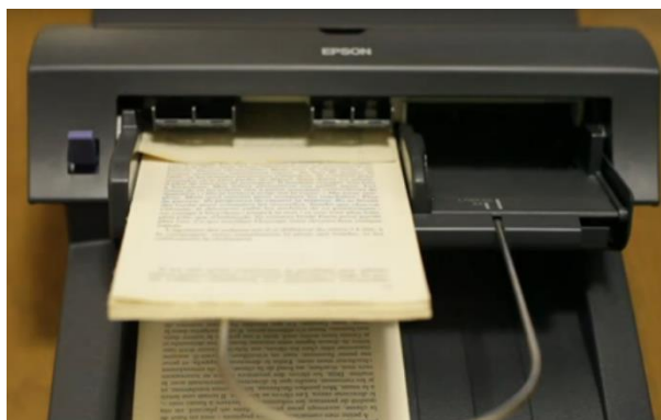
Slika 5. Skeniranje razrezane knjige uz pomoć ADF dodatka na skeneru Epson.
