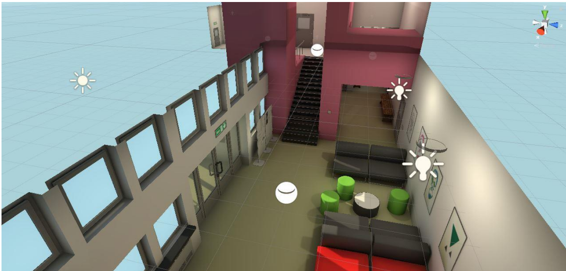
Slika 21. Lijevo je prikazano direkcionalno svjetlo koje simulira sunce, na sredini scene je Reflection Probe koji pridodaje refleksije modelima i desno su dva point svjetla koji simuliraju žarulje.
