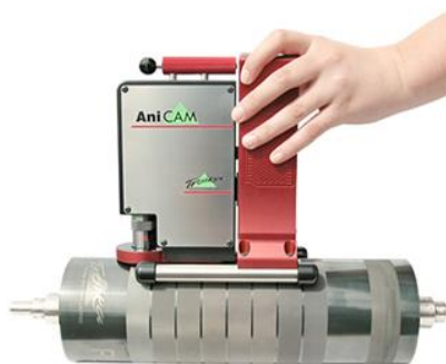
Slika 21. Troika AniCAM 3D mikroskop
