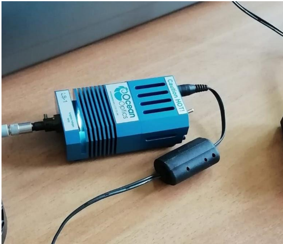
Slika 14 – Izvor svjetla, LS-1 (Tungsten-halogen lampa)
