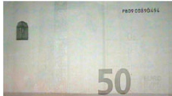
Slika 61 Naličje novčanice od 50 EUR pod IR svjetlom
