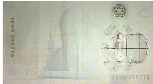
Slika 55 Naličje novčanice od £5 pod IR svjetlom
