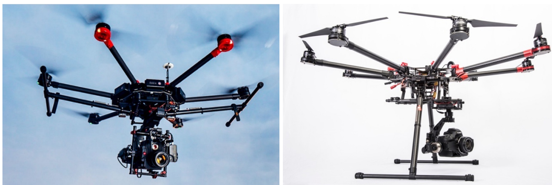
Slika 31. DJI Spread Wings S1000 dron s eksternim uređajima za snimanje i fotografiju
