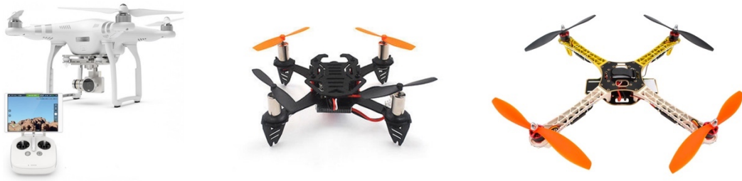
Slika 12. S lijeva na desno: RTF dron s upravljačem, BTF dron bez upravljača, ARF dron bez odašiljača i prijemnika
