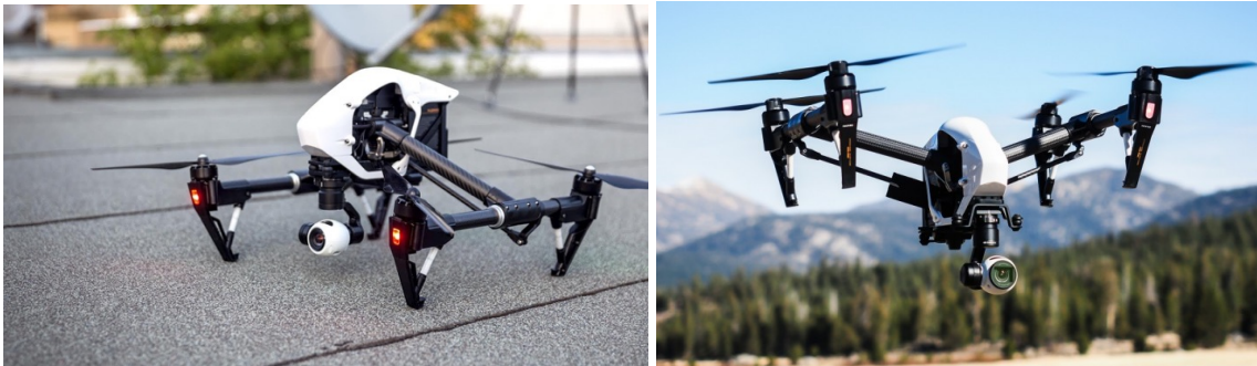
Slika 27. Pozicije tijela drona Inspire 1 sa osnovnom X3 kamerom
