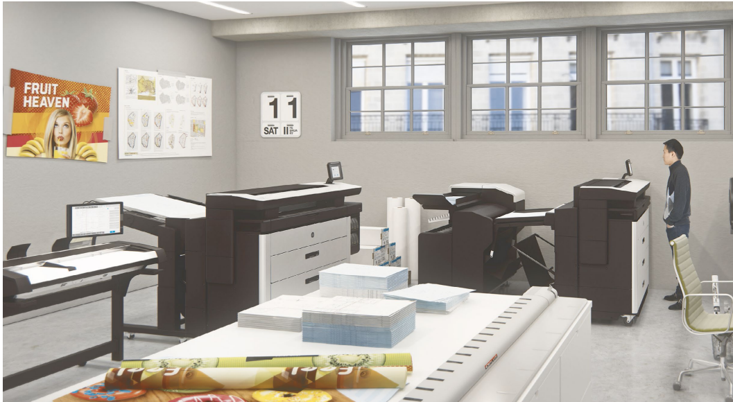
Slika 27. HP PageWide XL 8000 s dodacima – stol za izlaganje i uređaj za savijanje araka [19]
