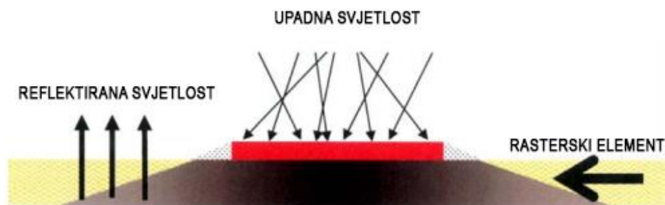
Slika 16. Optička deformacija rasterskog elementa ( Izvor: http://repro.grf.unizg.hr )
