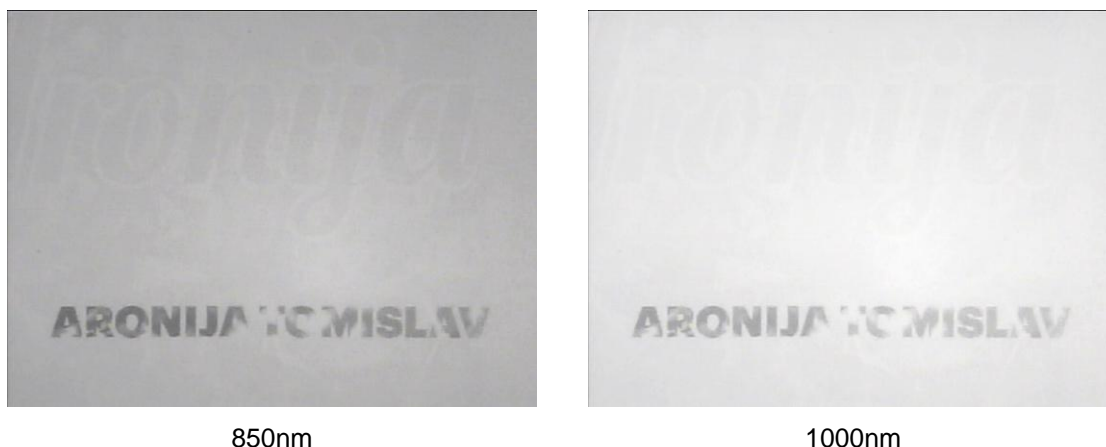
Slika 22. Dio otisnute zamišljene etikete soka od aronije snimljen na stroju Projectina u 6 različitih valnih dužina
