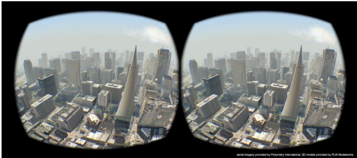
Slika 1.b Pogled unutar VR uređaja - slika koju korisnik vidi kada koristi uređaj (izvor: Virtual Reality, LaValle)
