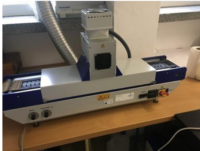
Slika 12. UV sušač Technigraf Aktiprint L 10-1
