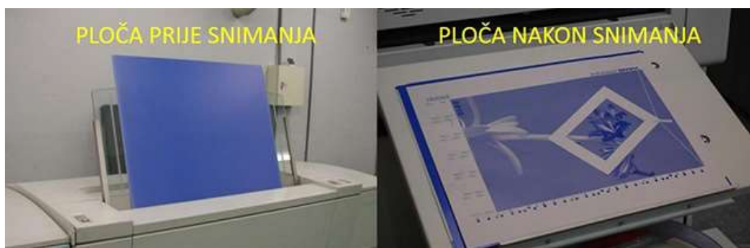
Slika 4. Tiskovna forma ( https://www.tiskara-dikopa.hr/offset-tisak/ )
