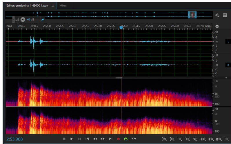
Slika 51: valni i spektralni prikaz snimljenog zvuka aluminijskog lima
