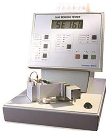
Slika 14. Lorentzen & Wettre bending tester
