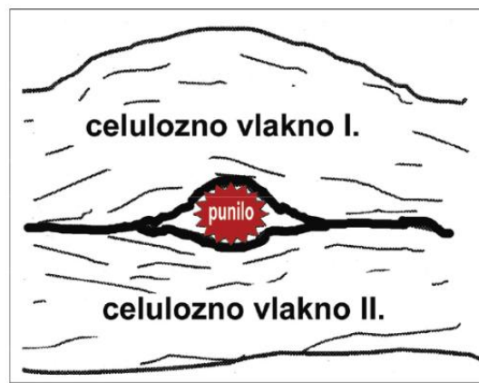
Slika 30. Čestica punila smještena između vlakana [3]
