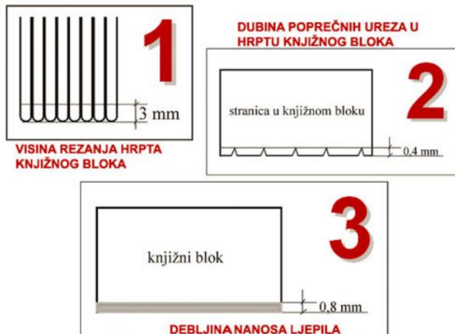
Slika 41. Prikaz redoslijeda tehnoloških operacija obrade hrpta knjižnog bloka [39]
