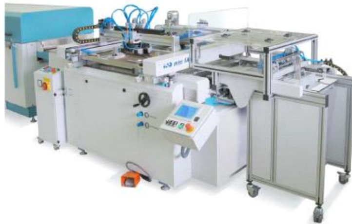
Slika 10: Potpuno automatski tiskarski stroj za sitotisak
