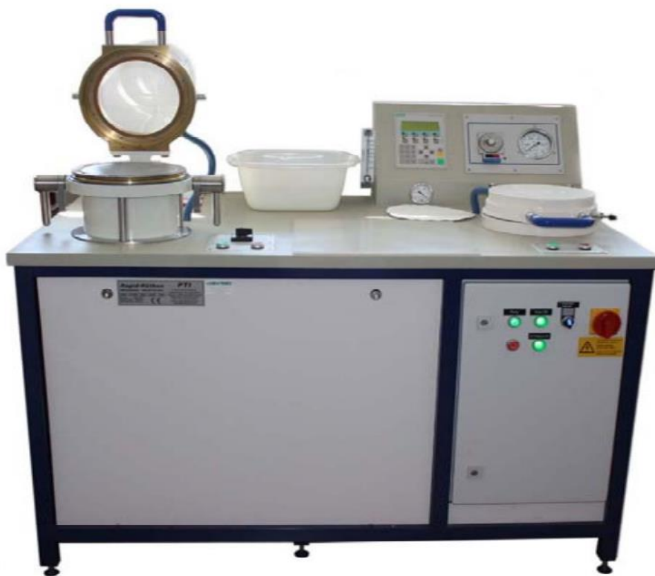
Slika 12: Uređaj za automatsku izradu laboratorijskih listova [5*]
