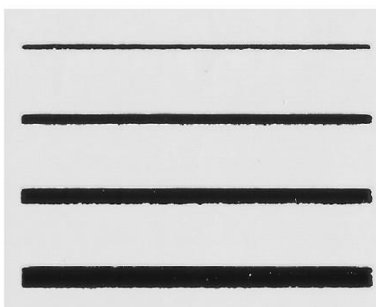
Uzorak 8 (debljina nanosa 21 \mu\text{m} i brzina otiskivanja 0,240 m/s)
