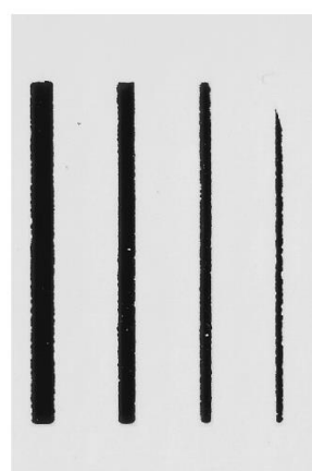
Uzorak 9 (debljina nanosa 21 \mu\text{m} i brzina otiskivanja 0,159 m/s)
